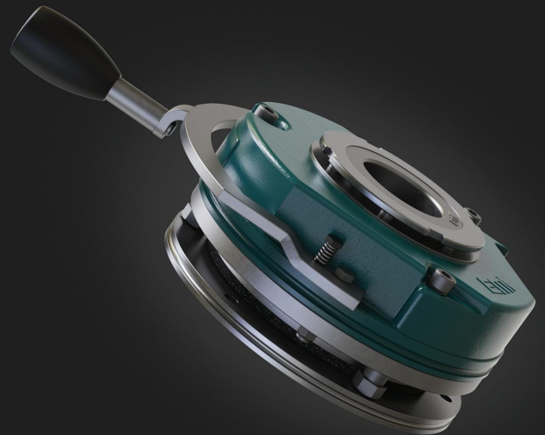
I freni della serie YBF, che hanno una struttura compatta, sono sistemi di facile installazione che si attivano in caso di interruzioni di corrente controllate o non controllate. Viene utilizzato per mantenere gli alberi mobili nella posizione desiderata e arrestare l'inerzia della rotazione per un funzionamento sicuro.
